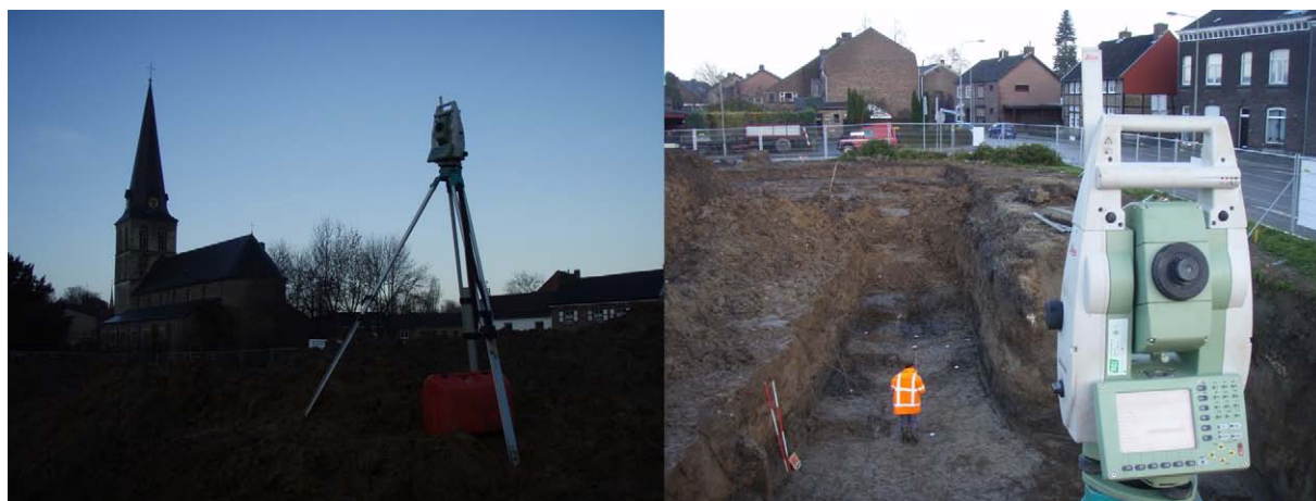
Afb. 2.10 Gebruik van de Robotic Total Station tijdens het onderzoek. Links de Robotic Total Station, rechts het inmeten van de sporen met behulp van de prismastok.
